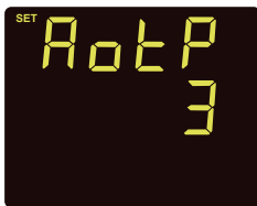
Fig 3-19 AO1 Parameter Setting
